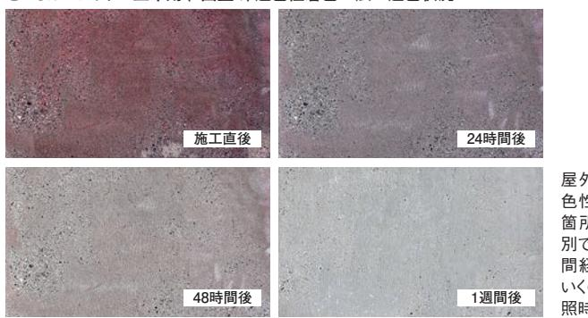
屋外暴露にて試験。退色性着色工法では施工箇所が目視で簡単に判別できるようになった。時間経過とともに退色していくのが分かる(季節・日照時間により変動あり)
