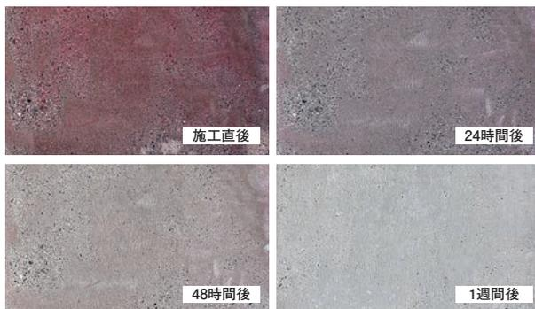
屋外暴露にて試験。退色性着色工法では施工箇所が目視で簡単に判別できるようになった。時間経過とともに退色していくのが分かる(季節・日照時間により変動あり)
